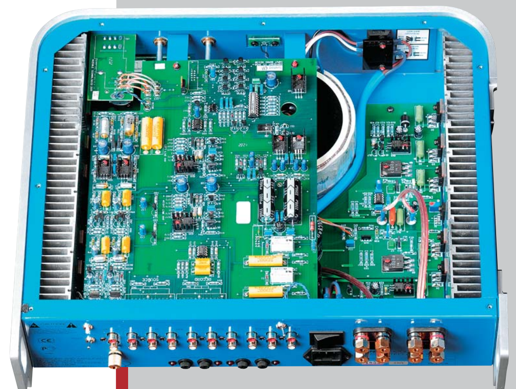
Секции предварительного усилителя и усилителя мощности расположены на одном шасси, но физически разделены
