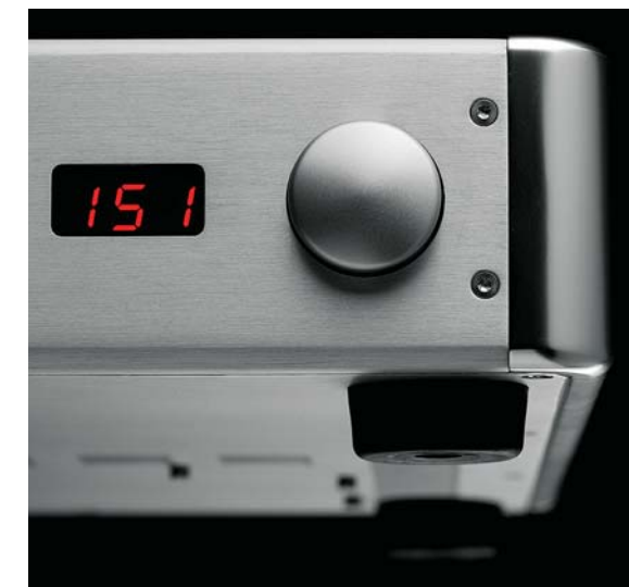
Цифровой индикатор уровня выходного сигнала показывает цифры от "0" до "151"
